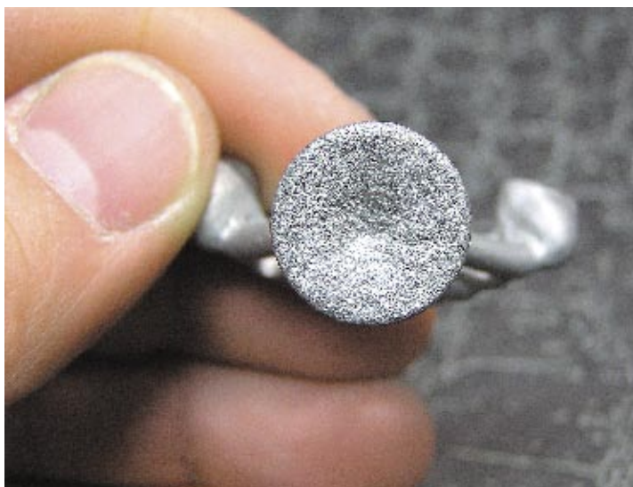
Rys. 9. Poprawnie odlany stop
